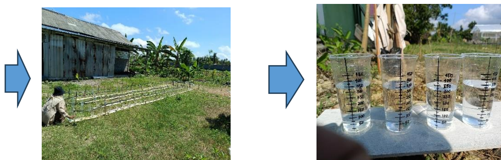
Gambar 6. Pengukuran keseragaman distribusi irigasi tetes.
